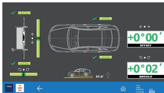
La struttura è allineata al veicolo in modo corretto ed è possibile procedere alla calibrazione del radar o della telecamera.
