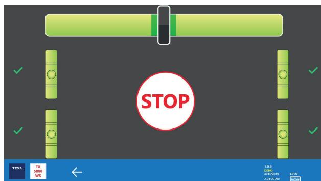
È necessario posizionare i 4 rilevatori CCD paralleli alla superficie di lavoro e centrare lo sterzo. Una volta soddisfatte queste condizioni viene visualizzata la scritta "STOP".
