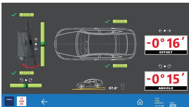
La dicitura "OFFSET" indica quanto l'RCCS 2 sia fuori centro rispetto alla linea mediana del veicolo. "ANGULO" indica invece di quanto l'angolo di imbardata della struttura sia fuori centro rispetto al veicolo.
