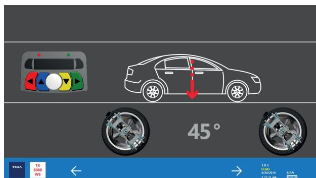
Posizionare i 4 sensori sugli appositi aggrappi ed eseguire il Run Out. A questo punto arretrare il veicolo fino a che gli aggrappi non saranno inclinati di 45°. Successivamente il veicolo viene spostato in avanti fino a riportarli in posizione verticale.
