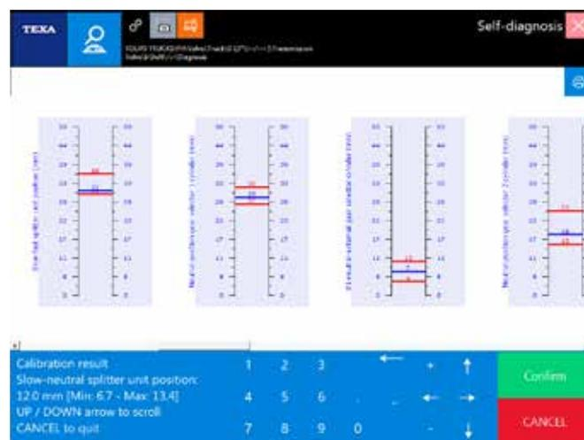
Figura 111: Regolazione: Calibratura cambio
