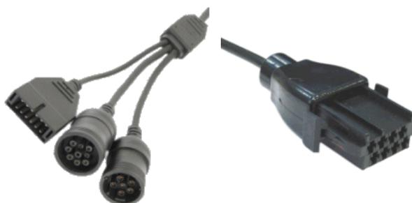
Figura 44: Connettori standard America e proprietario Volvo
