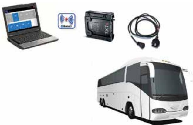
Figura 25: Schema di connessione per l'Autodiagnosi
